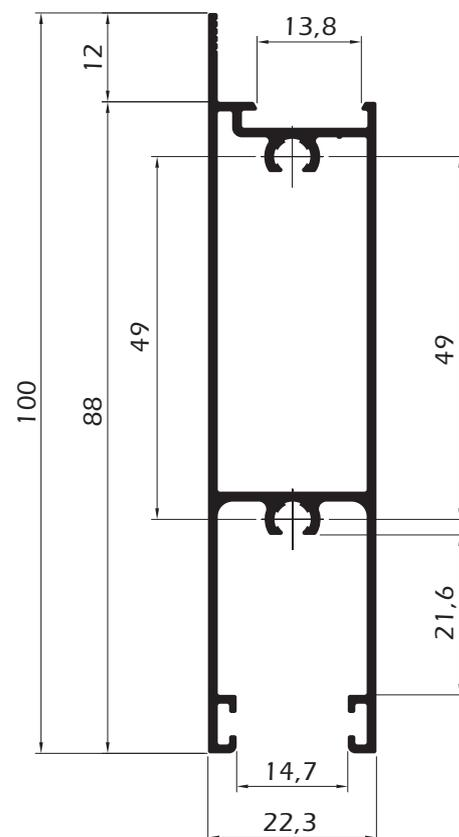
**P 1482\*** | 0,940 Kg/m | Folha com Baguete - Montante - Reforços ST-044
