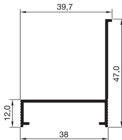
**P 1472\*** | 1,094 Kg/m | Perfil Macho Conexão CL-006
