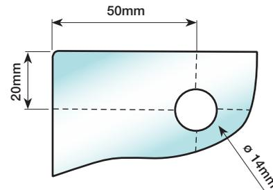
Furação para Puxador 2630 -  $\varnothing 14\text{mm}$
