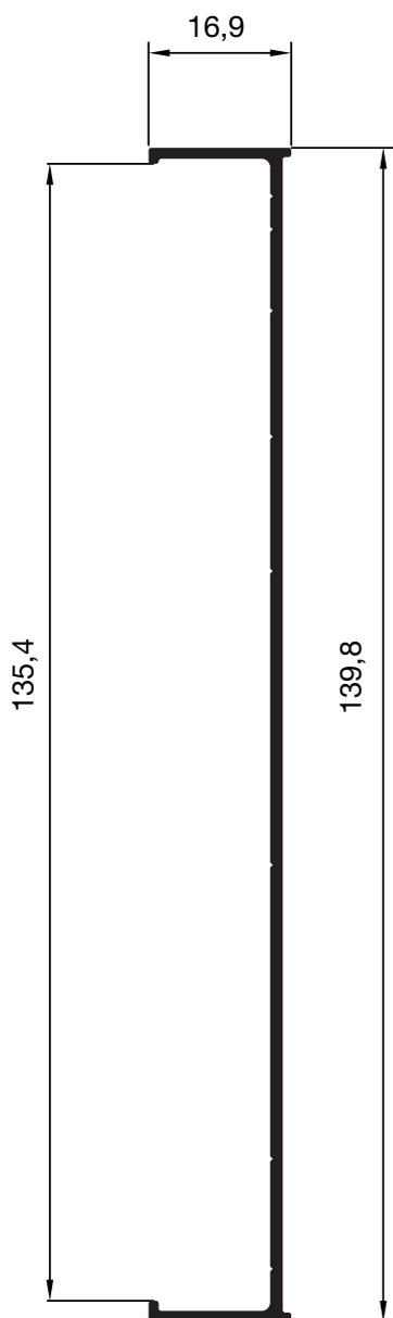
**P 1440\*** | 1,204 Kg/m | Caixa Recolhedor Integrada TI-018
