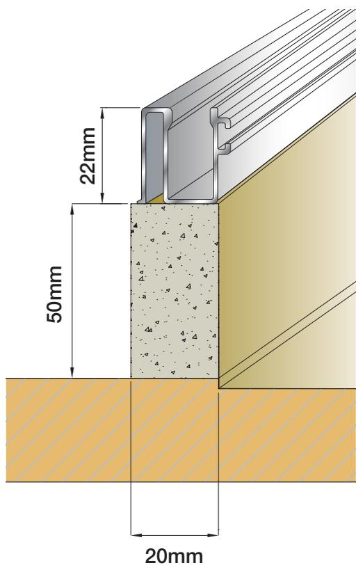
**Detalhe do perfil guia inferior onde em determinadas regiões adota-se a colocação de pedra para a formação de um rebaixo extra.**
