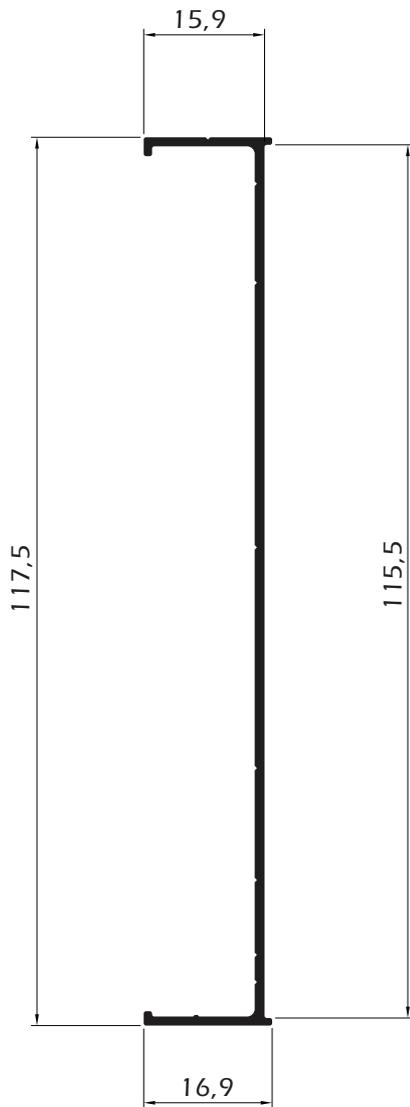
**P 1431\*** | 0,982 Kg/m | Caixa Recolhedor Integrada TI-025
